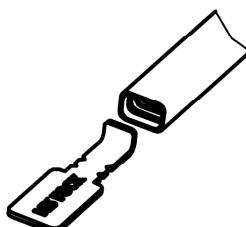
Установить вкладыш в нижнюю часть сломанной клюшки. На половину длины.
