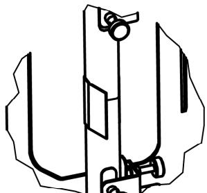
После основных действий смешайте смолу с отвердителем (используйте весы). Залейте сверху в полость клюшки смесь.
