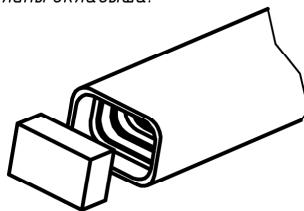
Для установки уплотнителя используйте толкатель MR Lock.
