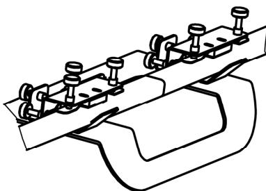
Установите штатив MR FIX на край стола и зафиксируйте.
