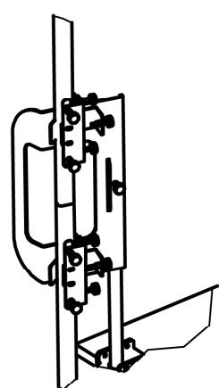
Отрегулируйте положение частей клюшки спомощью юстировочных болтов.
