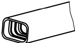
Установить уплотнитель в нижнюю часть сломанной клюшки. На половину длины вкладыша.
